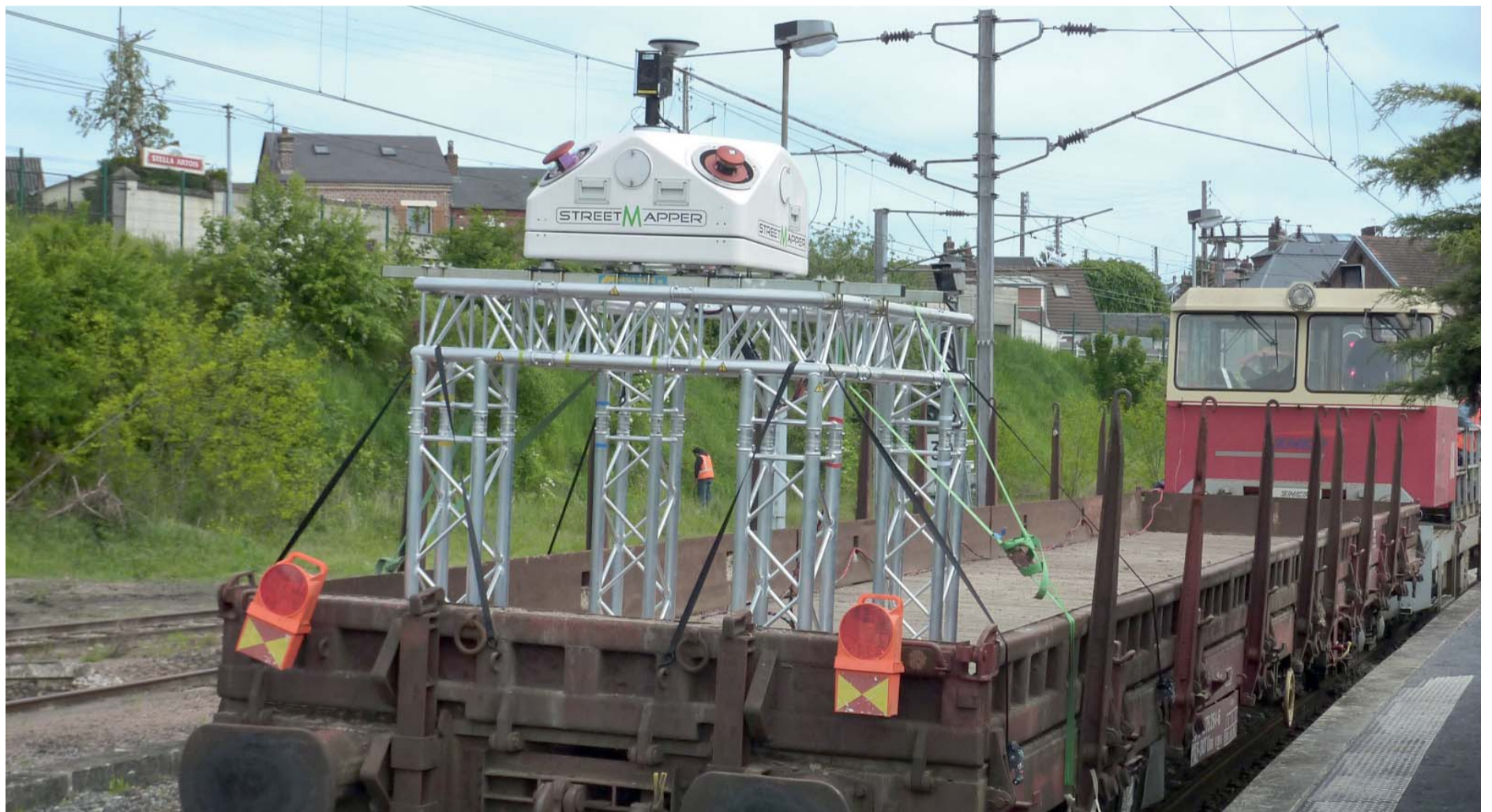
Le scanner dynamique est placé sur un wagon plat
