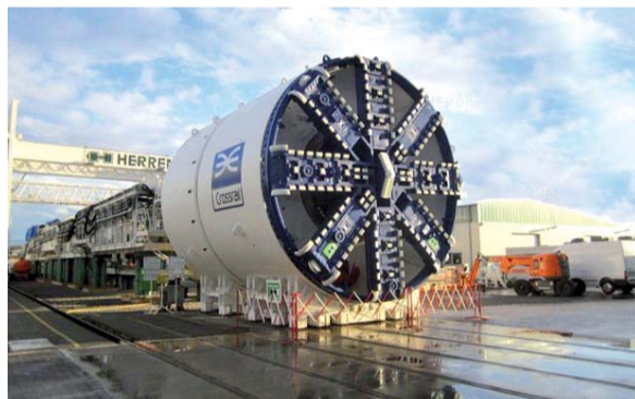
L'un des 8 tunneliers
