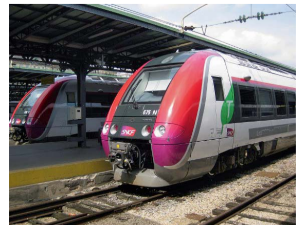
Rame automotrice SNCF bi-mode -électrique et diesel- et bi-courant
