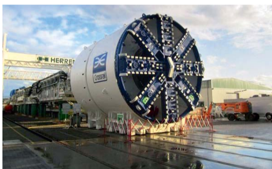
L'un des 8 tunneliers
